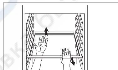
Полку над нижним дверным отделением и отделением для хранения овощей не следует переставлять, так как она обеспечивает правильную циркуляцию воздуха внутри холодильника. Полки с поднятым краем следует устанавливать поднятым краем к задней стенке холодильника, для того чтобы хранимые продукты не касались панели охлаждения.
